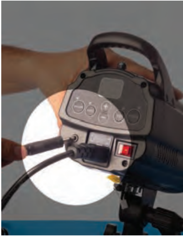
▲ اتصال سیم سینکرون رادیوتریگر به فلاش | تصویر ۱۳۶
